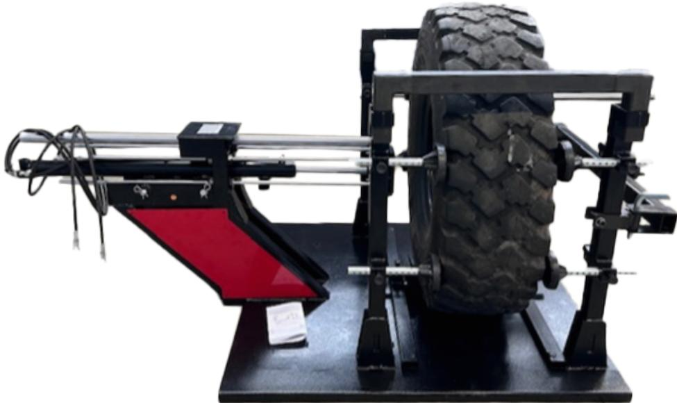
L'attrezzatura offre **elevata precisione e controllo delle operazioni**, grazie a sistemi di movimentazione progettati per operare in modo progressivo e controllato, consentendo all'operatore di gestire ogni fase di lavoro con accuratezza e sicurezza. Le soluzioni tecniche adottate permettono di mantenere un **controllo costante** durante l'estrazione del sistema Run Flat, riducendo il rischio di danneggiamenti allo pneumatico e ai componenti interni.
